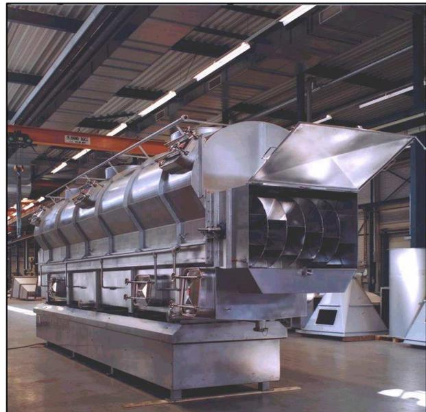
*Secador de lecho fluido Ventilex*
