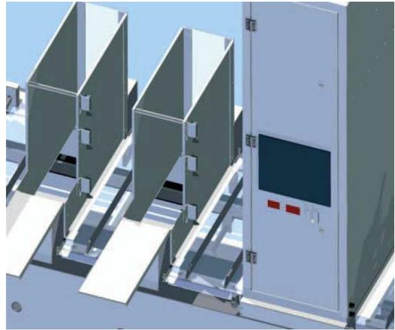
*Detector de molde vacío e intercambiador de molde*
